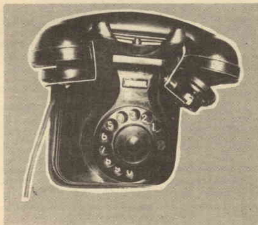
Sopra: « Blocco A » con il microfono e l'auricolare montati a lato; il blocco « A » inserito nell'apparecchio telefonico.
