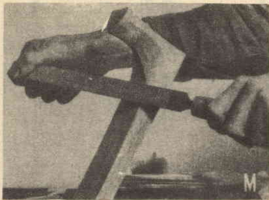
Fig. 14 - Dopo le precedenti operazioni, il «collo» sarà rifinito a raspa.
